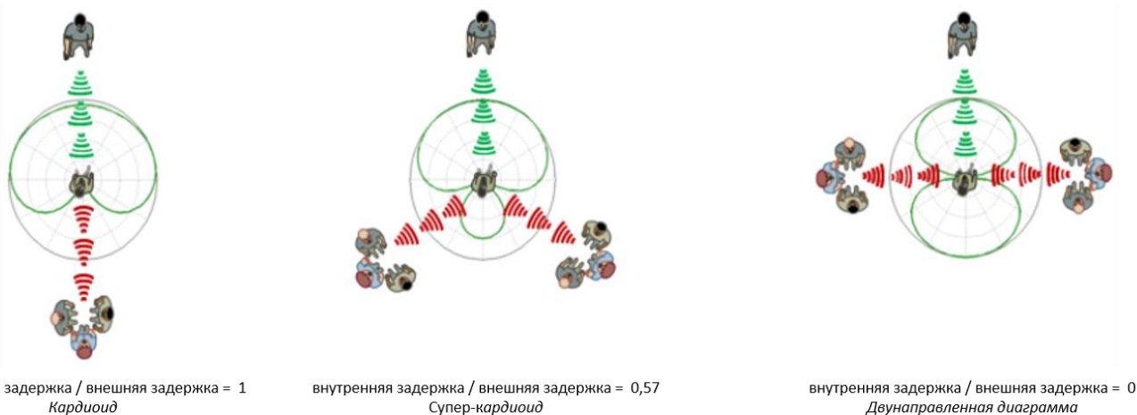
Рис. 6: Варианты полярных диаграмм, полученные путем изменения внутренней задержки сигнала X_2(t) относительно фиксированной внешней задержки X_1(t) . Используется с разрешения Michael Kramer с соавт.
